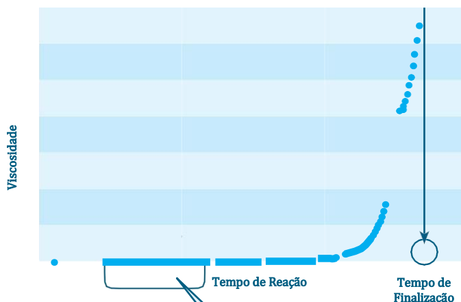
Figura 2: Medição da viscosidade ao longo do tempo. (Estudo interno da Rousselot, Laboratório de Aplicação da EMEA – Agência Europeia de Medicamentos, 2017)
